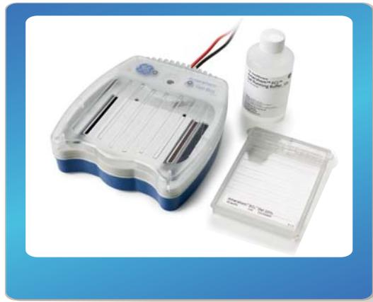
Amersham™ ECL™ Gel system预制胶水平蛋白电泳系统由Amersham ECL预制胶及Amersham ECL电泳槽组成。预制胶结合独特水平设计的电泳槽，方便用于高质量的蛋白电泳分离。
